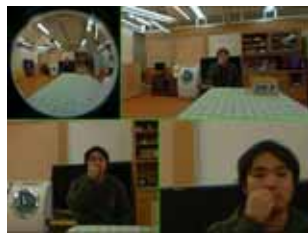
広視野多重解像度カメラ 180度の広視野画像と複数の望遠視野画像を同時刻に取得
