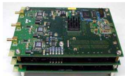
富士通ビジョンボード 動き検出、パターンマッチング計算において、汎用PCの6倍の高速処理性能
