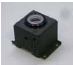
広視野多重解像度カメラ 180度の広視野画像と複数の望遠視野画像を同時刻に取得
