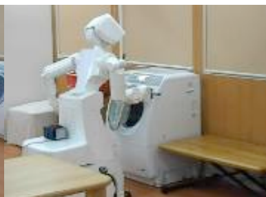
(5)洗濯機ボタン押し
